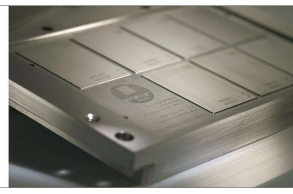
Musterplatten-Werkzeug: Sieben Oberflächen mit unterschiedlichen Glanzgraden sind auf der Platte abgebildet.
