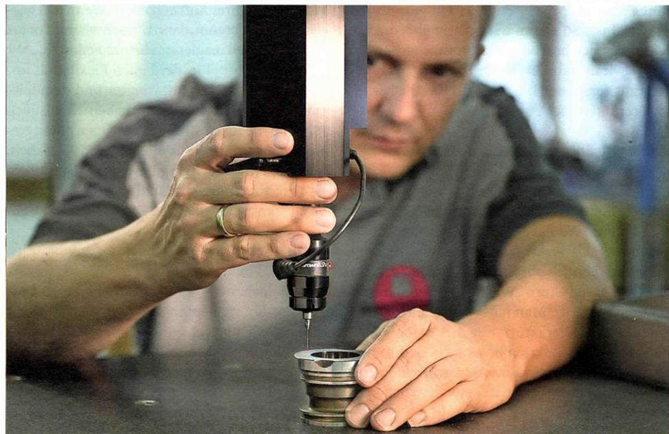
Ein geometrisches Maß im Bereich von wenigen tausendstel Millimetern kann man ohne Hilfsmittel nicht verifizieren. Daher hat Bestenlehrer jetzt in eine leistungsfähige Koordinatenmessmaschine investiert.
