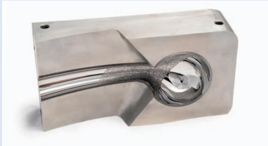
Kunststoffbauteil, das durch das polierte Spritzgusswerkzeug effektiver entformt werden kann.
